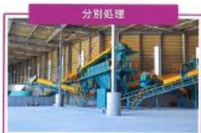
破砕・分別施設 破砕・分別施設 異物の除去や粒径調整などを行い、浄化処理施設への進入手前で前処理が行われます。 処理能力 100t/日
