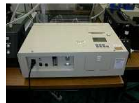
図 3. 131 繊維状粒子自動計測器の例
