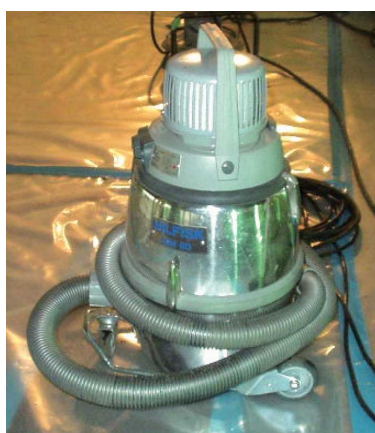
図 3. 58 高性能真空掃除機
