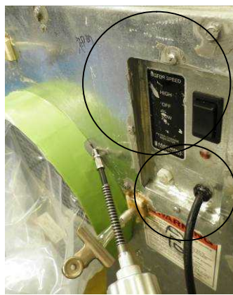
図 3.78 漏れの発生しやすい箇所の例
