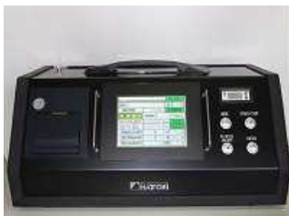
図 3. 131 繊維状粒子自動計測器の例
