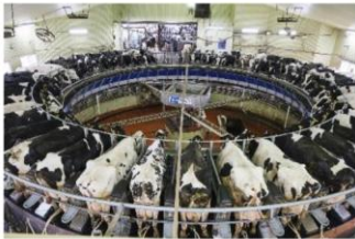
搾乳設備 (ロータリーパーラー)
