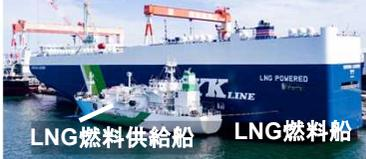
LNG燃料供給船 LNG燃料船
