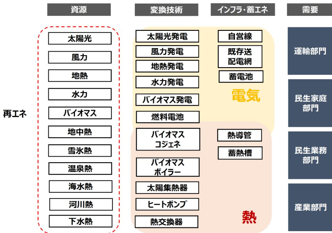
図 4-3-1 再エネの種類と変換技術
