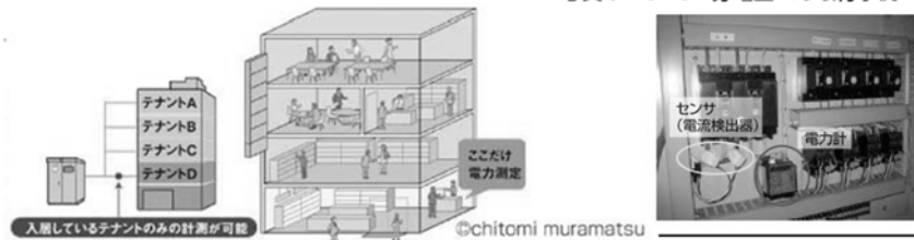
図V-3-8 多回路電力モニターの設置イメージ
