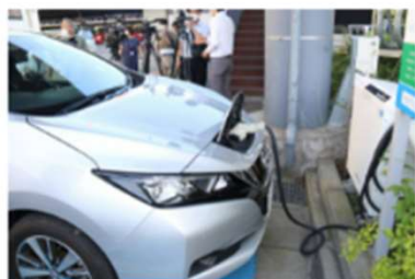
当日、EVから市庁舎へ放電している様子（その1）
