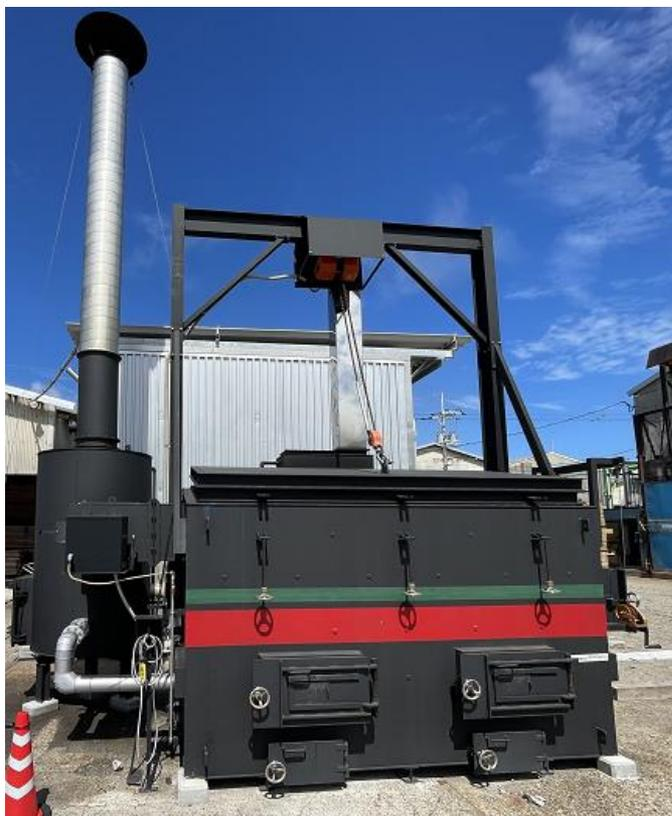
◆用途/チップ燃料の追加乾燥、燃料は土場で発生するバークと端材など未利用バイオマス
