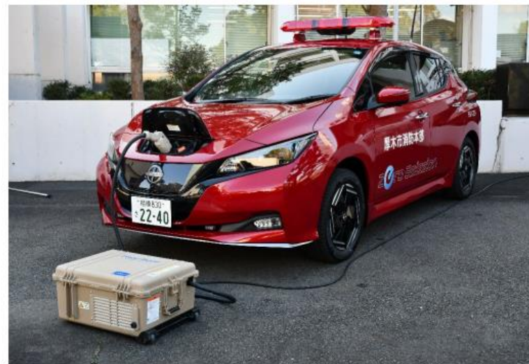
外部給電装置と接続されたEV消防指令車
