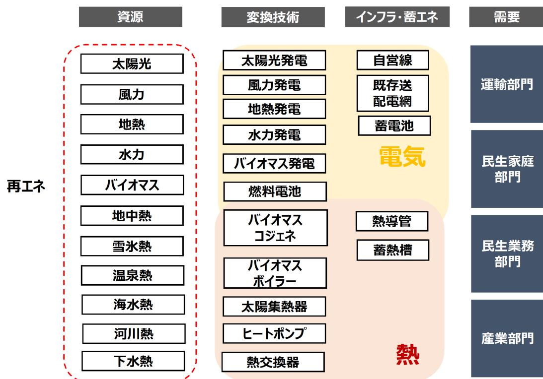
図 2-65 再エネの種類と変換技術
