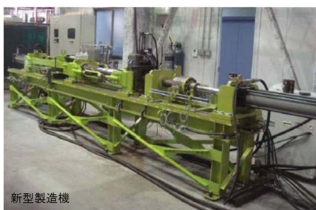
図 2 バイオコークス製造装置
