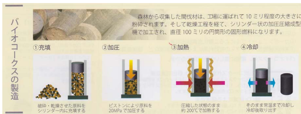
図 3 バイオコークス製造工程
