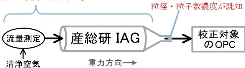
$$\text{粒子計数効率} = \frac{\text{校正対象OPCが測定した粒子数濃度}}{\text{AIST-IGが発生した粒子数濃度}}$$
