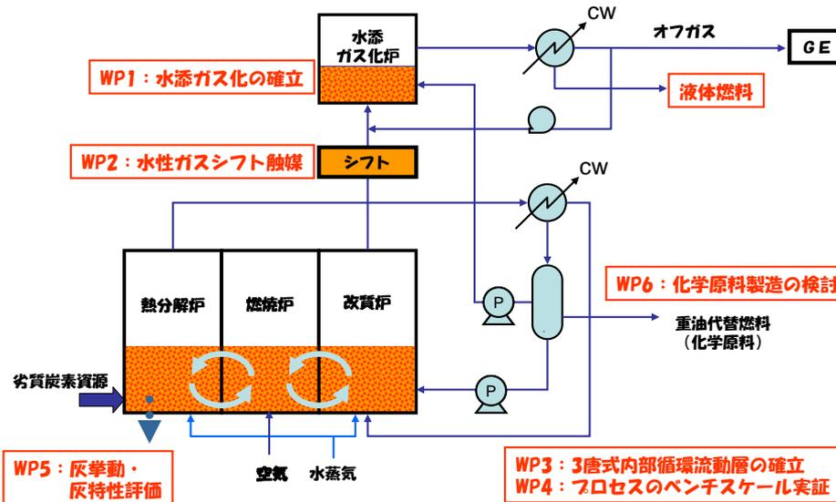
小口需要に対応できる液体燃料を併産することで、地域への導入障壁を引き下げ、小規模バイオマス利用を拡大しうるエネルギー転換技術を実証する。
