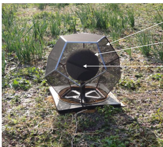
試作・2次Wind Screen (DH -160) 20cmφ全天候型Wind Screen (RION WS-03) 計測用1/2 in. マイクロホン
