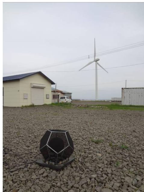
写真(2)-3 風車騒音の測定風景-1 (W28周辺)
