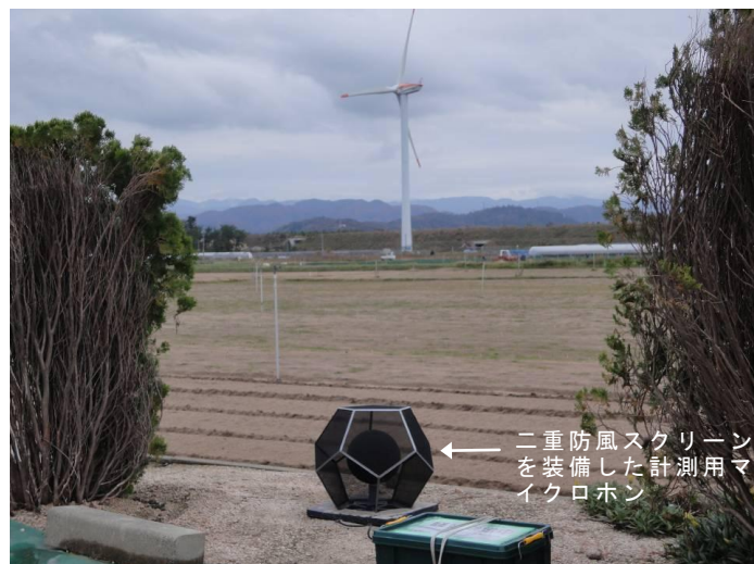
写真3 広帯域音圧レベル計を使用した風車騒音の測定の例
