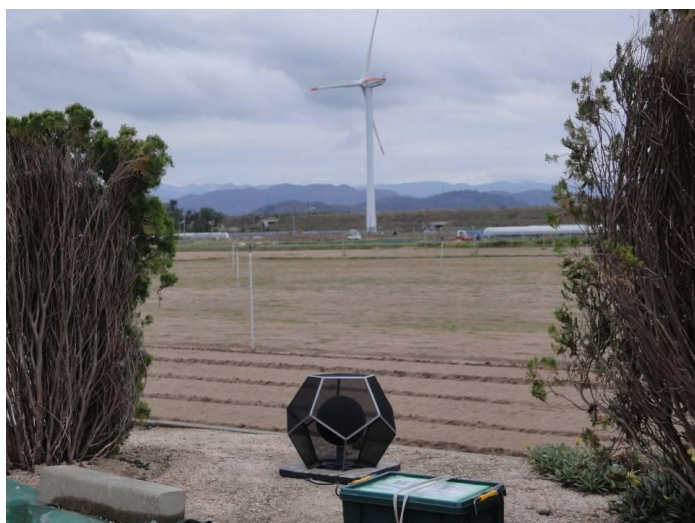
写真(2)-2 風車騒音の測定風景-1 (W09周辺)
