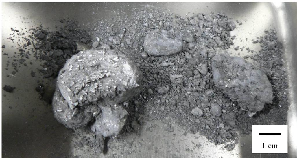
補足資料 図1-3 回収したSiセルをそのまま使い、Cu-Si合金形成を試みた試料
