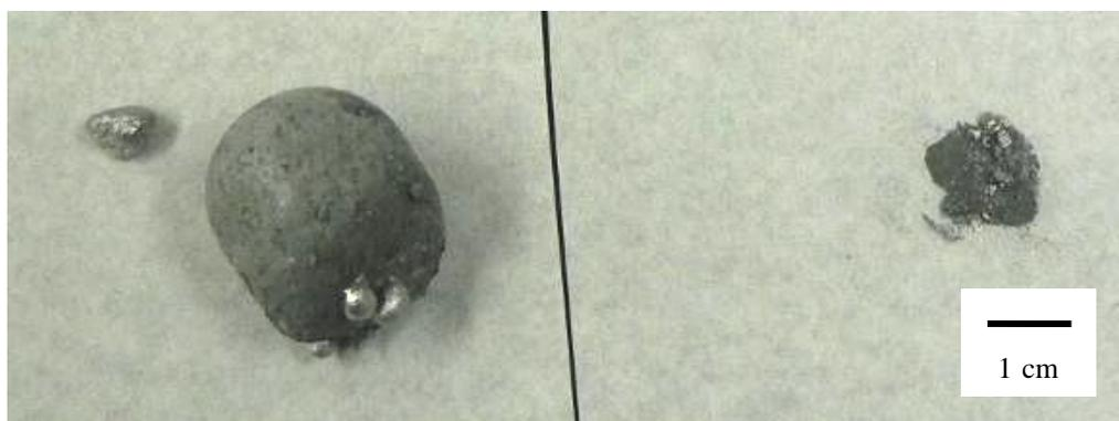
補足資料 図1-5 塩酸洗浄したSiセルを使い、Cu-Si合金形成を試みた試料
