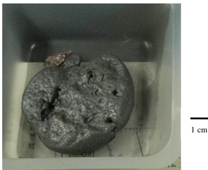
補足資料 図1-6 合金化が不十分であった試料を熔融CaCl<sub>2</sub>中に保持した試料
