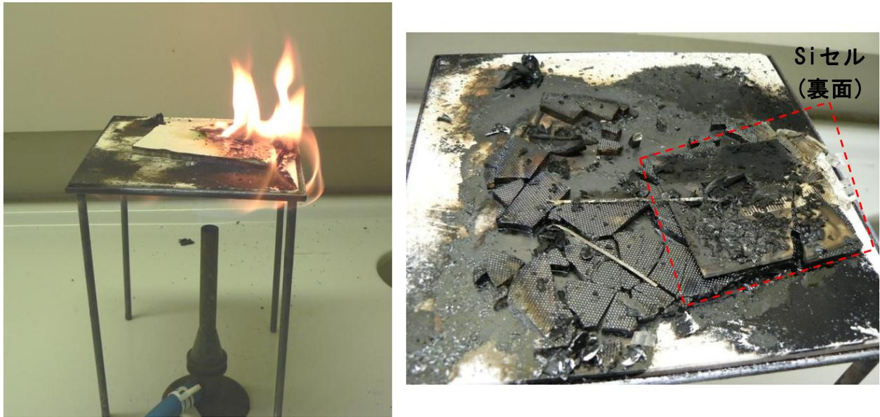
図13 熱処理によるEVA除去の様子(左)と冷却後の試料(右)
