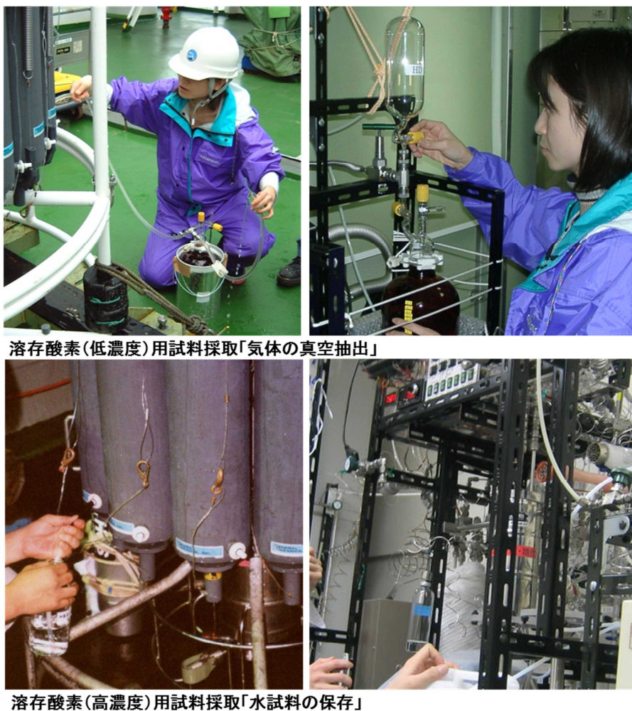
図(3)-4 溶存酸素の三酸素同位体組成 ( D^{17}O 値) 用試料の採取方法
