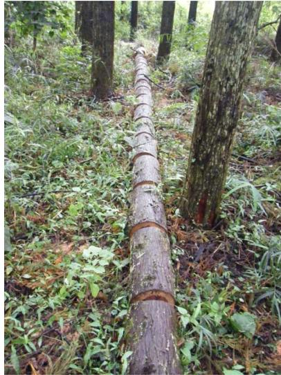
図(1)-7 幹体積計測のために対象木を玉切りにした様子。
