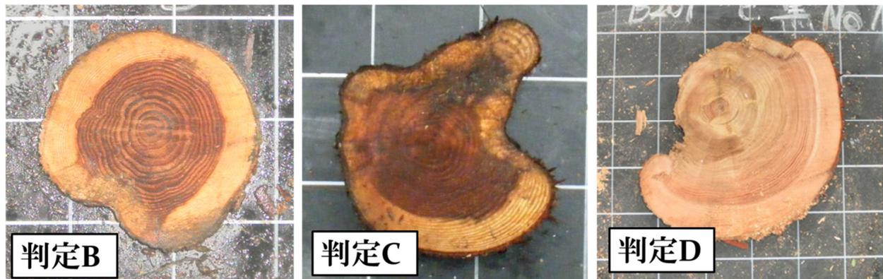
図(1)-41 病害判定と幹形状の関係（被害判定：A 健全木、B 多少溝が生じている木、C くぼみが深くなっている木、D ねじれをおこしている に分類）。
