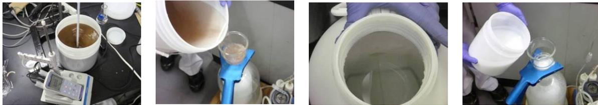
①焼却灰からリン抽出 ②残渣(脱リン灰)分離 ③抽出液→消石灰添加 ④析出リンの分離
