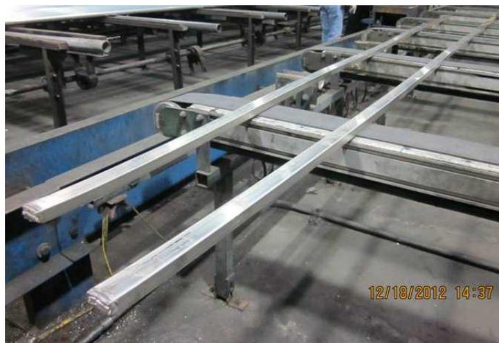
図 6.4 量産押出機による矩形断面押出材の作製状況
