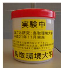
写真2-1 発信機と放流ボトルの形状
