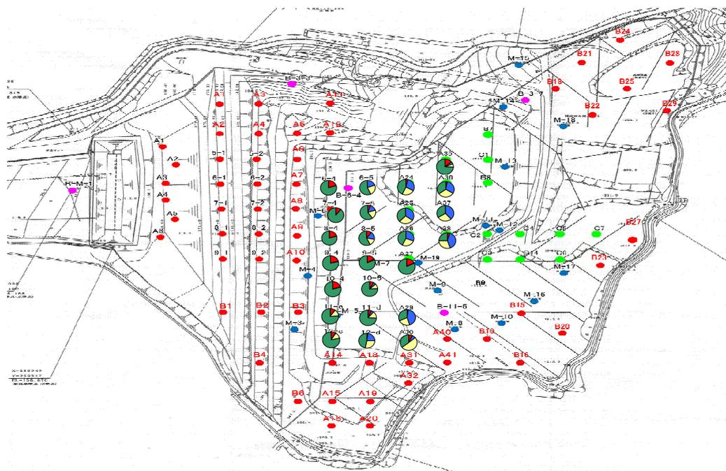
図 7-15 2010年12月6-9日ガス抜き管出口のガス成分
