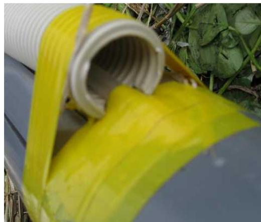
図 2-31 ガス採取チューブの設置状況
