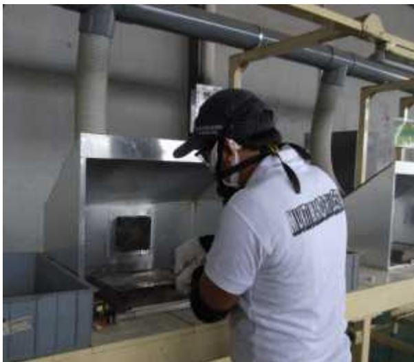
写真 3.1.9 ハンダを温めて部品を回収する様子
