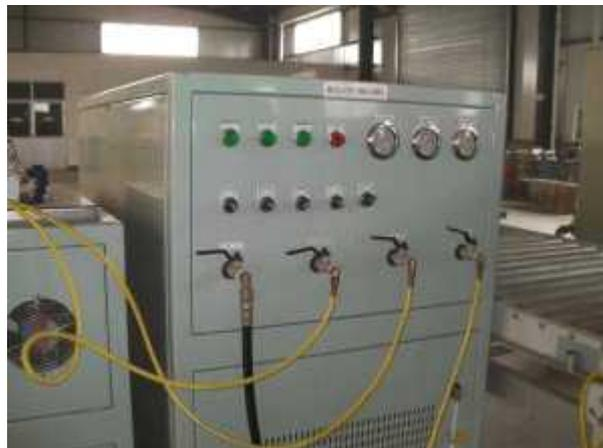
写真 3.1.14 冷蔵庫冷媒回収機
