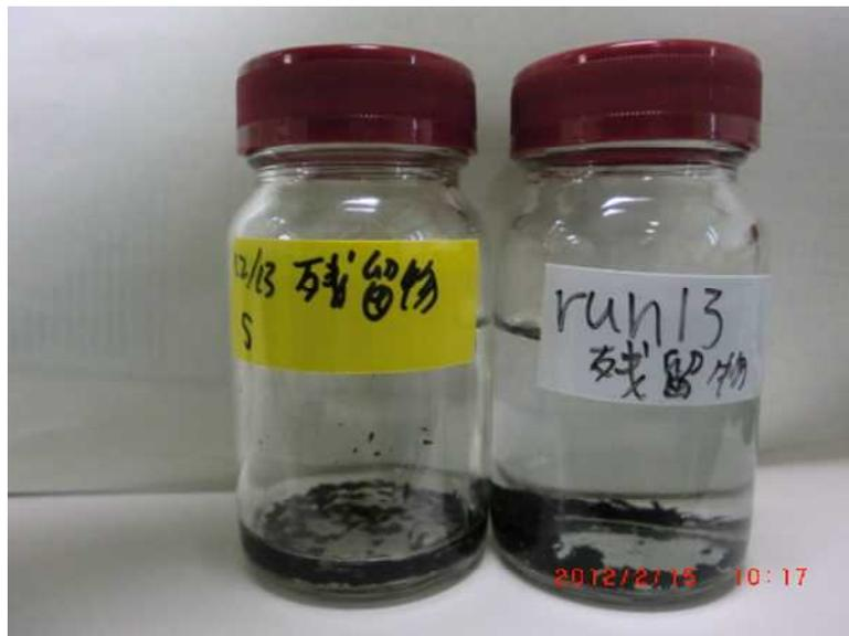
Fig. 6.2.1-11 スギの水熱試験（添加なし）（左）とスギの水熱試験（二酸化炭素添加）（右）の反応管内残留物
