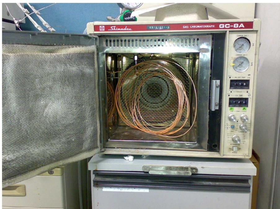
Fig. 4-4 .2-2 反応オーブン内写真
