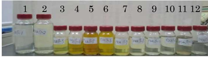
Fig. 6.2.1-4 スギの水熱試験サンプル (0.5wt%過酸化水素添加)
