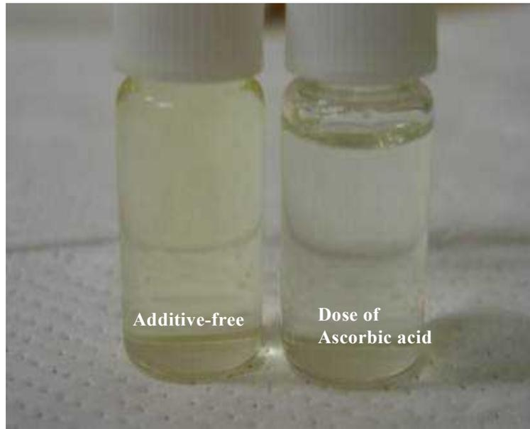
図 25 起泡クロマト分離後の泡沫液の様子 (左：無添加、右：アスコルビン酸添加)
