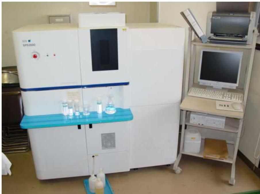
図 6 ICP 発光分光分析装置 (SPS3500、SII ナノテクノロジー社製)
