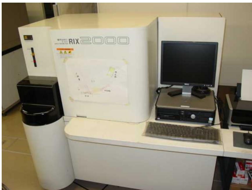
図 9 波長分散型の蛍光 X 線分析装置 (RIX2000, リガク社製)
