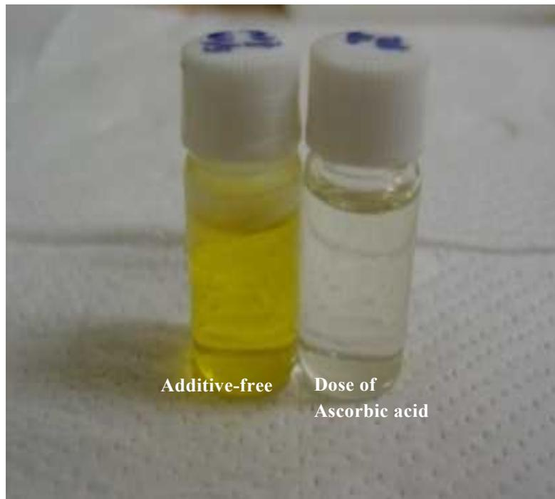
図 23 フィード溶液の外観 (右：アスコルビン酸添加、左：無添加)
