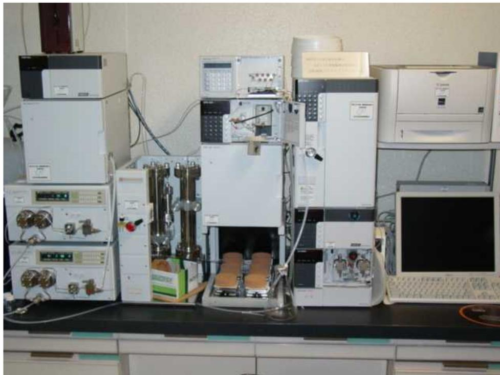
図3 分子量分布測定装置（GPC System-11、Shodex社製）
