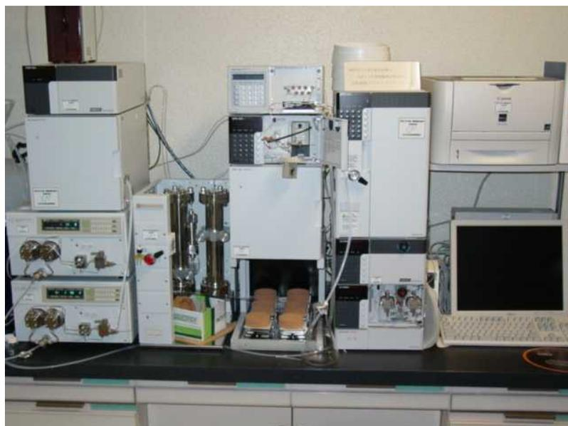
図 13 分子量分布測定装置 (GPC System-11, Shodex 社製)
