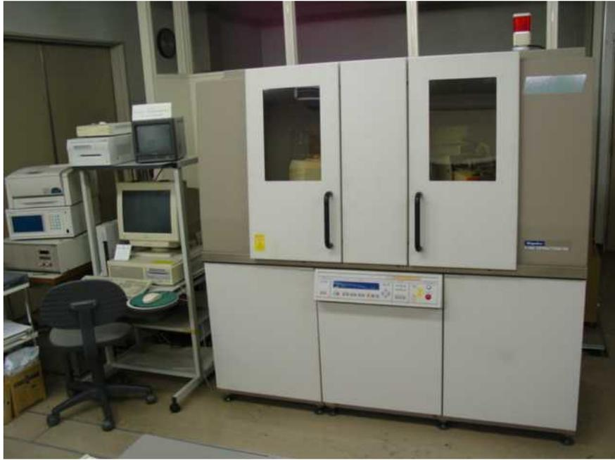
図 10 回転対陰極型の X 線回折装置(RINT2000, リガク社製)
