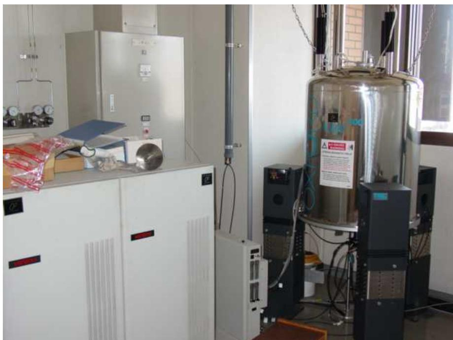
図4 核磁気共鳴測定装置（Unity INOVA400、バリアン社製）
