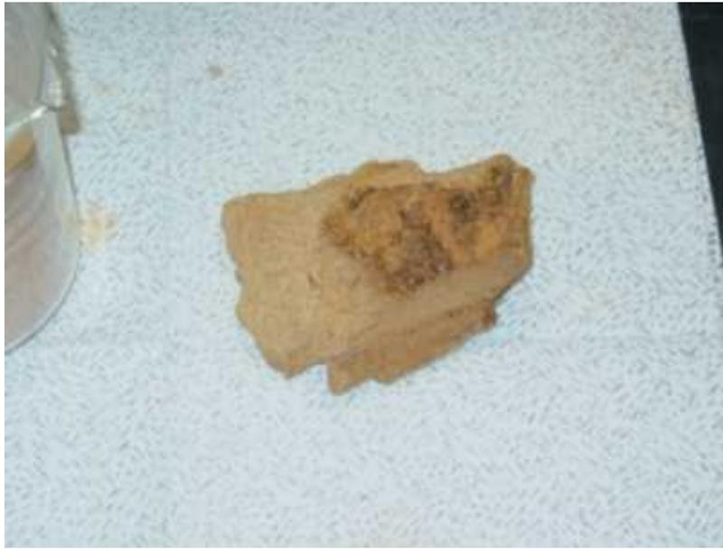
図 21 使用した亜鉛精錬残渣の外観
