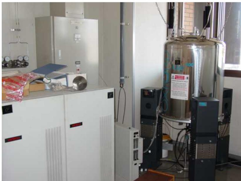
図 12 核磁気共鳴測定装置 (Unity INOVA400, バリアン社製)
