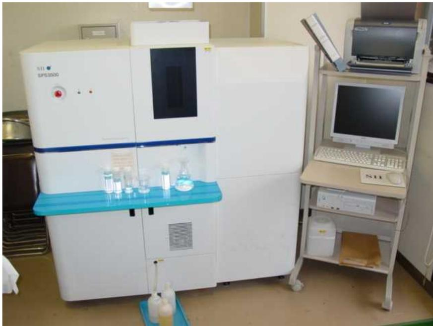
図 8 ICP 発光分光分析装置 (SPS3500, SII ナノテクノロジー社製)
