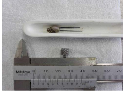
Fig. 2.19 空気酸化後コンデンサ
