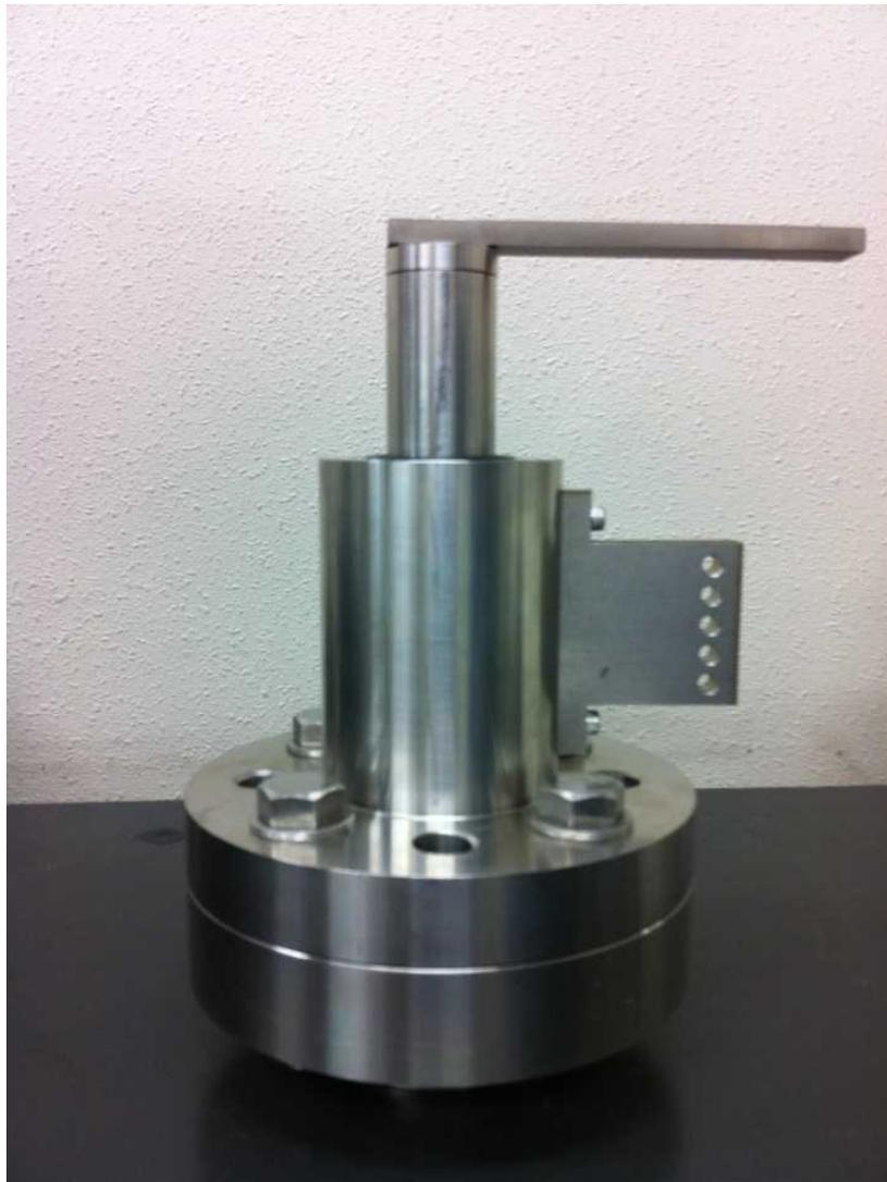
Fig. 3-1 超高压圧搾セル
