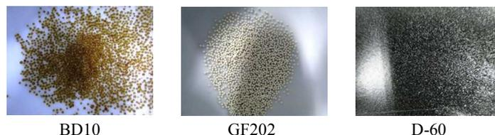
図 2-3-3 乾式洗浄で検討したイオン交換樹脂(BD10 と GF202)と無機系吸着剤(D-60)
