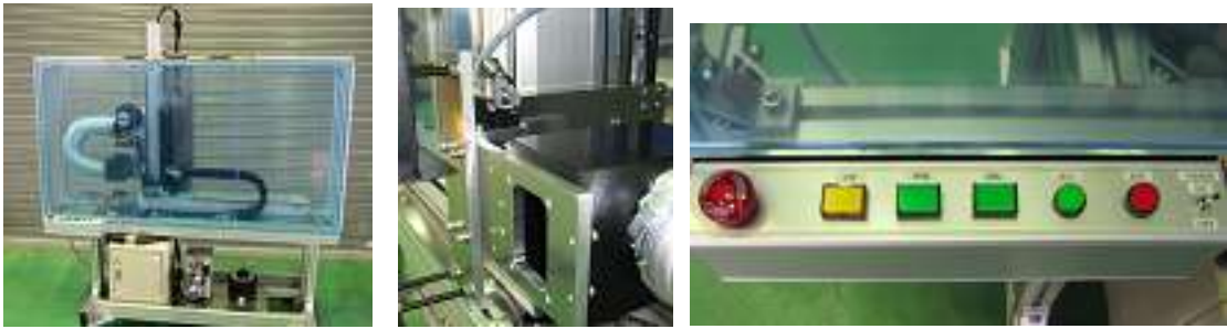
図2 スキャンロボット外観、反射鏡取り付け口、操作パネル
