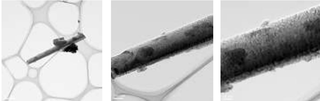
図 1 3 溶融後クリソタイルで撮影された繊維状形態
