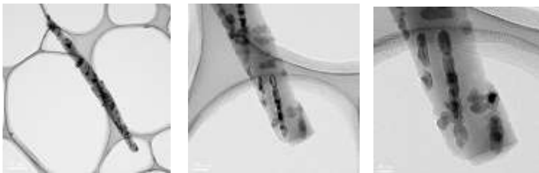
図 1 5 溶融後クロシドライトで撮影された繊維状形態
