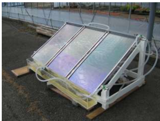
図 1 酸化チタン光触媒資材を用いた壁泉処理装置
