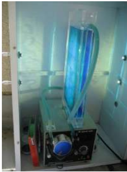
図1 アクリル反応槽（左；メチレンブルー溶液処理時、右；浸出水処理時）
