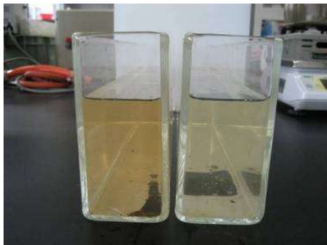
図4 処理水の色度の変化（左；対照、右；酸化チタン円板）
