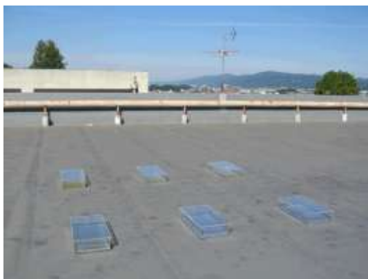
図 1 酸化チタン光触媒資材を用いた屋外における浸出水処理試験
