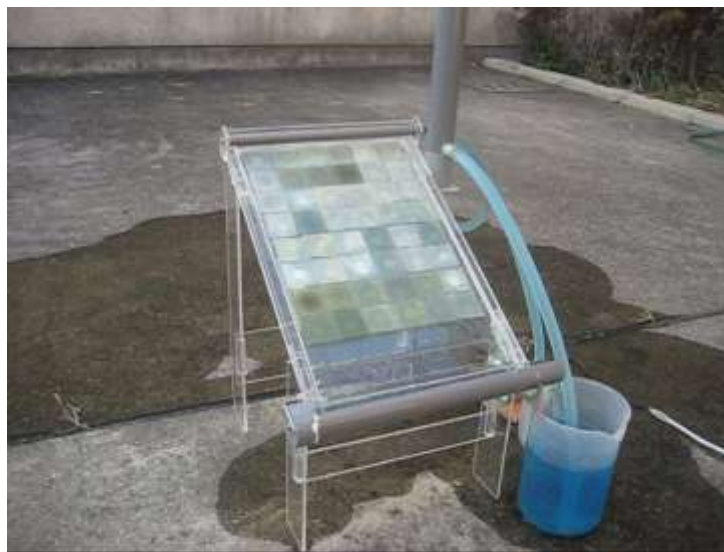
図 1 可視光応答基板を使った壁泉型処理装置
