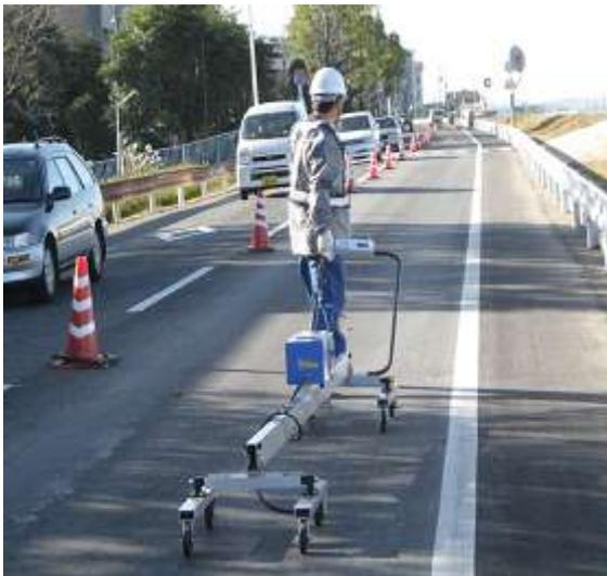
図 5.1-7 平坦性の測定（レーザー光式 3m プロフィールメータ）
