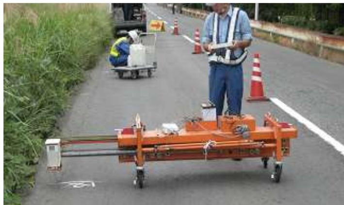
図 5.1-8 わだち掘れ量の測定（横断プロファイラー）
