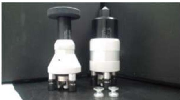
図 5.1-12 塗膜付着力試験機アドヒージョンテスター
