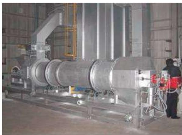
図 5.1-1 無水石膏製造用実験実証炉
