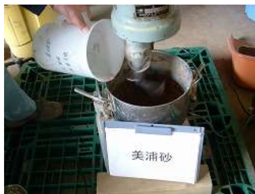
写真 4.3-2 含水調整 (注水)
