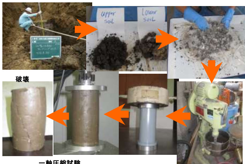
図 4.2-3 土試料の採取から一軸圧縮試験を実施するまでのプロセス
