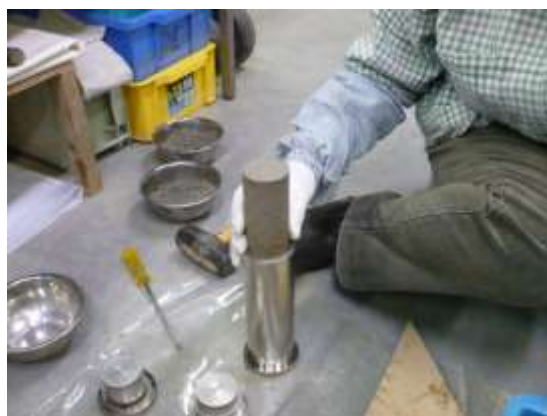
写真 4.3-8 供試体の作製手順④
