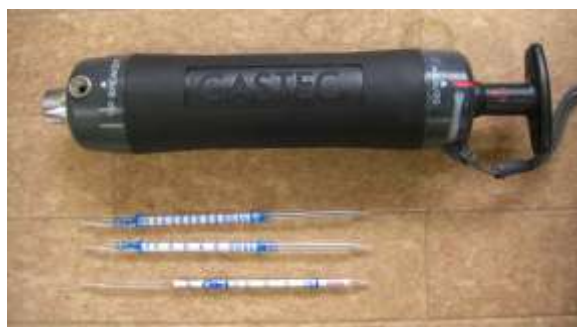
写真 4.3-11 吸引器とガス検知管
