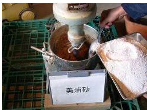
写真 4.3-3 半水石膏及び高炉セメント B 種の投入
