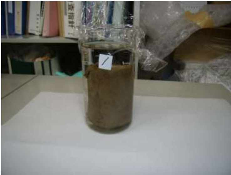
図 4.2-8 施工現場の実態を想定して実施したフッ素の溶出試験
