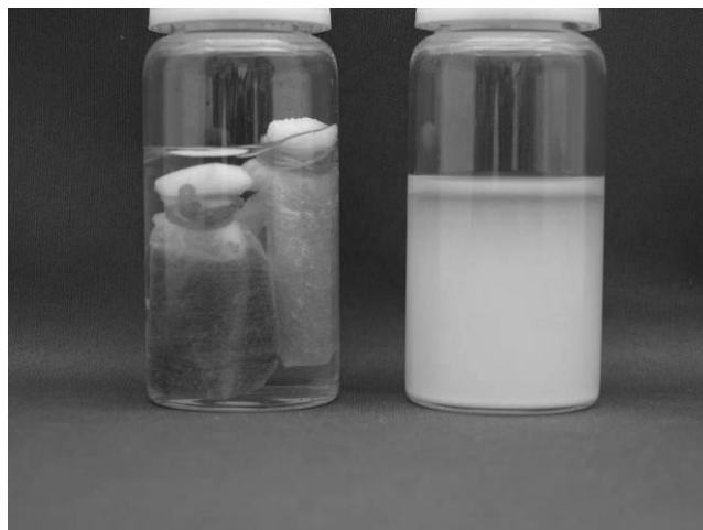
図 5 イオン交換樹脂を浸漬した蒸留水へのセッコウの溶解性 左: イオン交換樹脂浸漬 右: 蒸留水のみ
