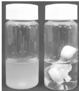
図 13 陽イオン交換樹脂によるセッコウの溶解挙動(左:イオン交換樹脂なし, 右:あり)
