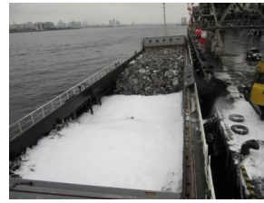
高発泡タイプ泡消火の状況
