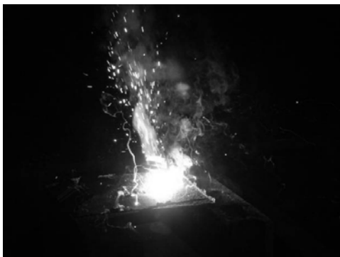
図 3.2.16 マグネシウムリボンに着火後のアルミニウム／酸化第二鉄のテルミット反応
