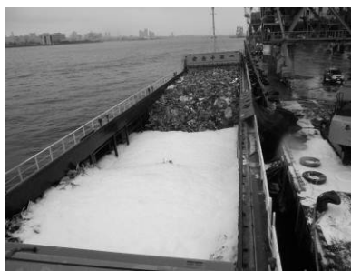
図 3.1.47 高発泡タイプ 泡消火の状況
