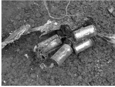
図 3.1.55 電池パック (電極に溶融アルミ付着)
