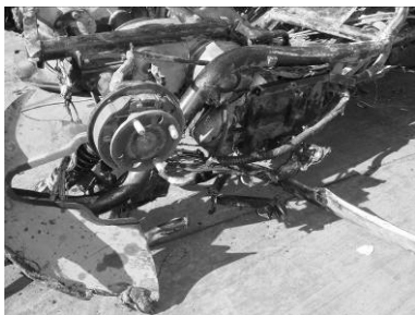
図 3.1.38 バッテリー架台 付近 (焼けが強い)
