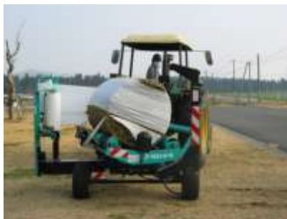
図 6-2 発酵 TMR 飼料の梱包・ラッピング状況
