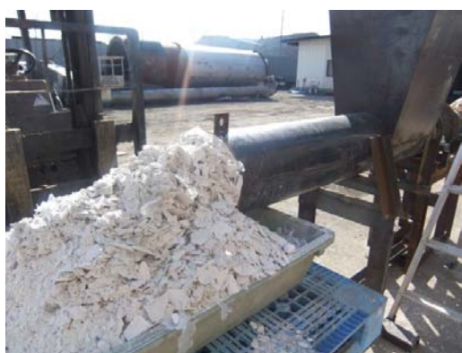
写真-6.4.2 先端テーブル付き狭ピッチスクリュウコンベア搬送試験での吐出状況
