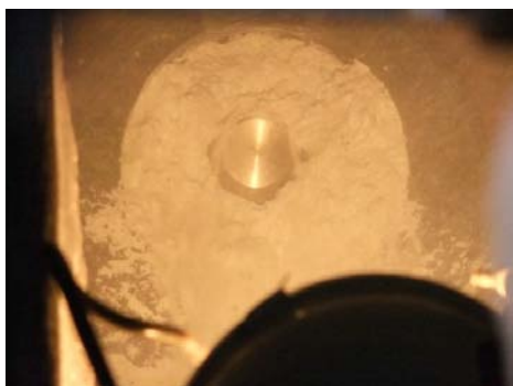
写真-6.3.3 テーパー付き変ピッチスクリュウコンベア 溶融炉接続搬送試験での吐出状況
