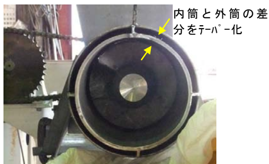
写真-6.3.1 テーパー付き変ピッチスクリュウコンベア 吐出口部分
