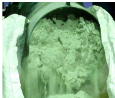
写真-6.3.2 テーパー付き変ピッチスクリュウコンベア 搬送試験での吐出状況
