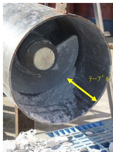
写真-6.4.1 先端テーブル付き狭ピッチスクリュウコンベア吐出口部分
