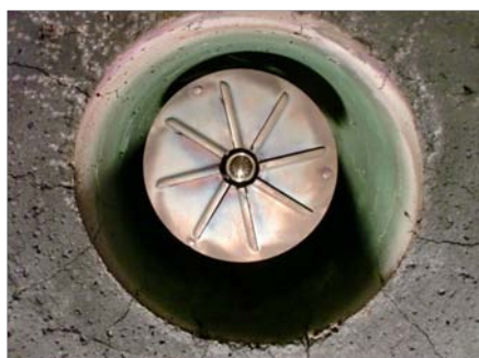
写真-6.2.1 先端当板付き広ピッチスクリュウコンベア 吐出口部分(正面、設置時)
