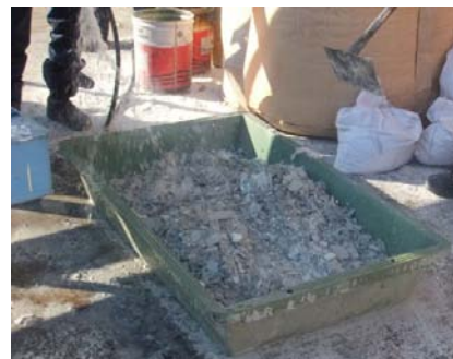
写真-6.4 搬送試験時に散水して湿潤 状態を再現したサンプル
