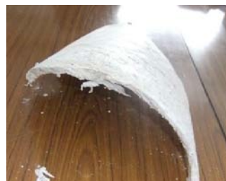
写真-6.3.4 テーパー付き変ピッチスクリュウコンベア 溶融炉接続搬送試験で生じた固形物 (スクリュウコンベアの外筒内側に付着硬化)
