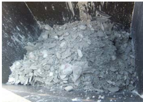
写真-6.3 石綿非含有スレート材 破碎試験途中でスクリュウコンベアのホッパに溜めた状態
