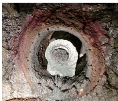
写真-6.2.3 先端当板付き広ピッチスクリュウコンベア 吐出口部分(熔融試験後)
