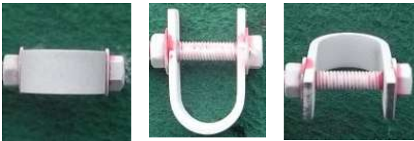
図 2 1 運転後浸透探傷試験結果
