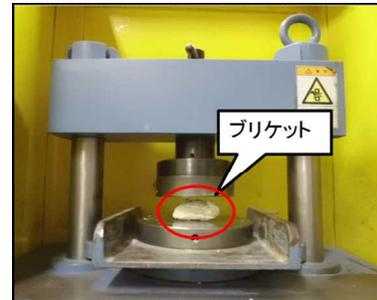
図.13 全自動耐圧試験機（前川製作所）
