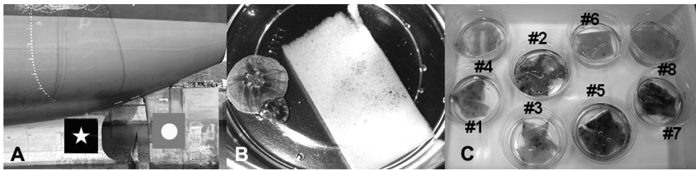
図3. A. ドック入り中の調査船舶、☆と○の異なる部位で塗料試験を実施。B. 付着試料の採取に用いたメラミンフォーム素材スポンジ。C. 付着試料の培養の様子（約2ヶ月後の培養試料）。
