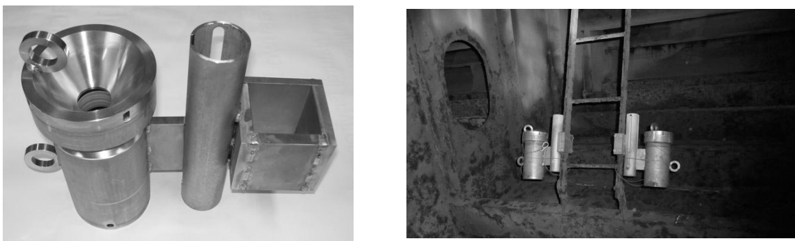
図 1. 作成した沈殿物捕集器（右）バラストタンク内に設置された沈殿物捕集器（約2年設置後）
