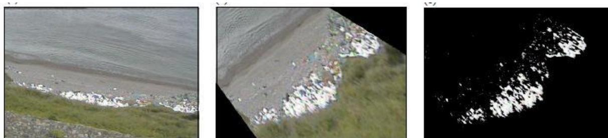
図4-2 ウェブカメラ1が得たjpg画像(左)と射影変換後の真上画像(中)、輝度より判定した漂着ゴミ位置の画素分布(右図の白い画素)
