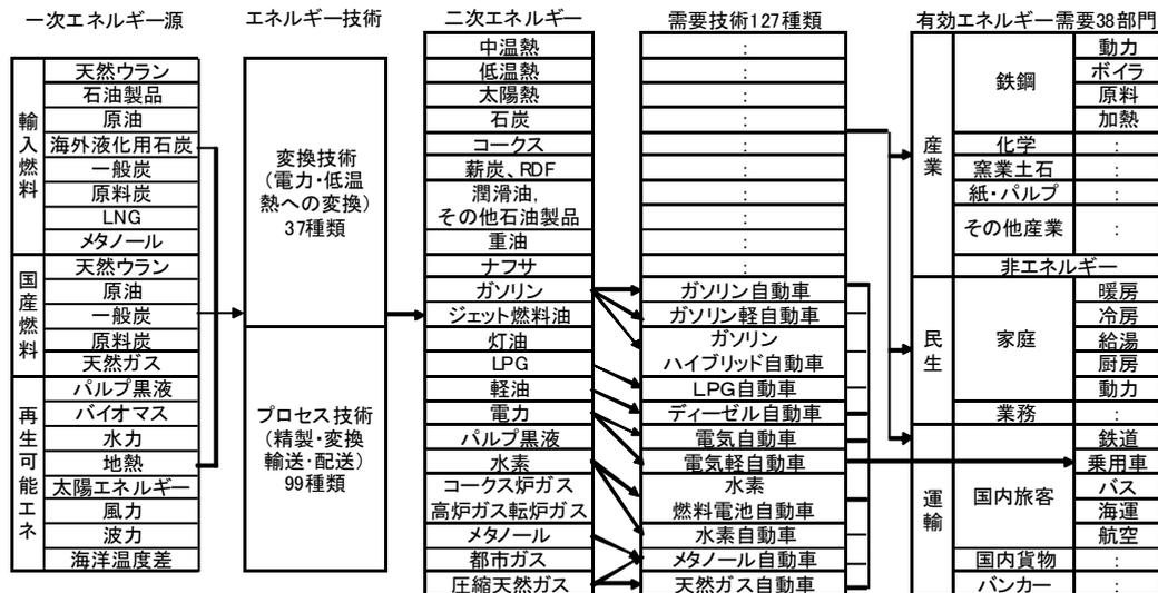
図1.2 MARKALでモデル化した我が国のエネルギーシステムの概要
