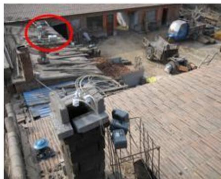
図6 煙突からの排気粒子(手前)ならびにバックグラウンド大気の捕集(後方の赤丸部分)
