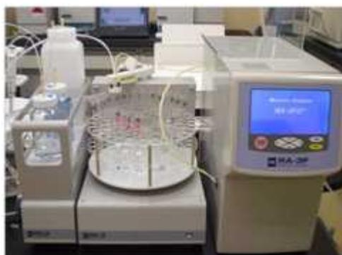
図(1)-9 水銀分析計(NIC製 RA-3000FG+)
