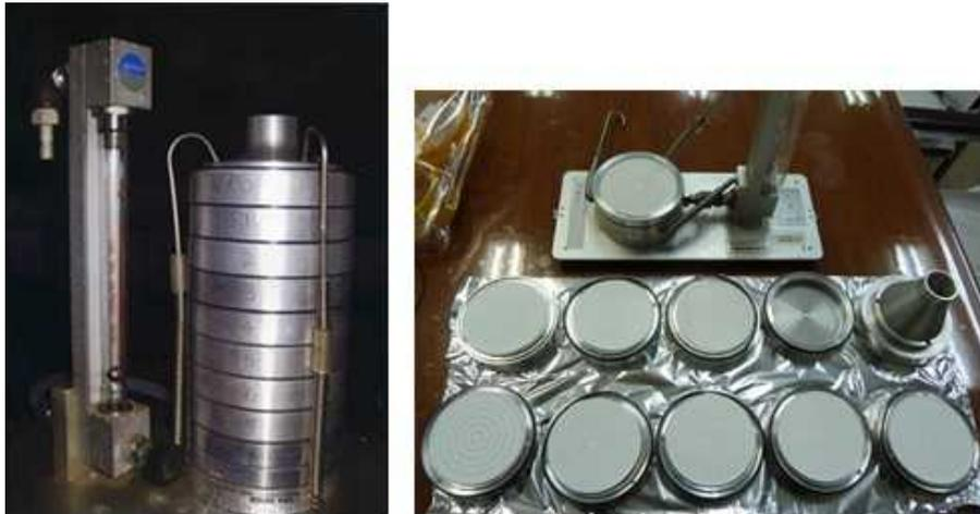
図(2)-11 ローボリュームアンダーセンサンプラー
