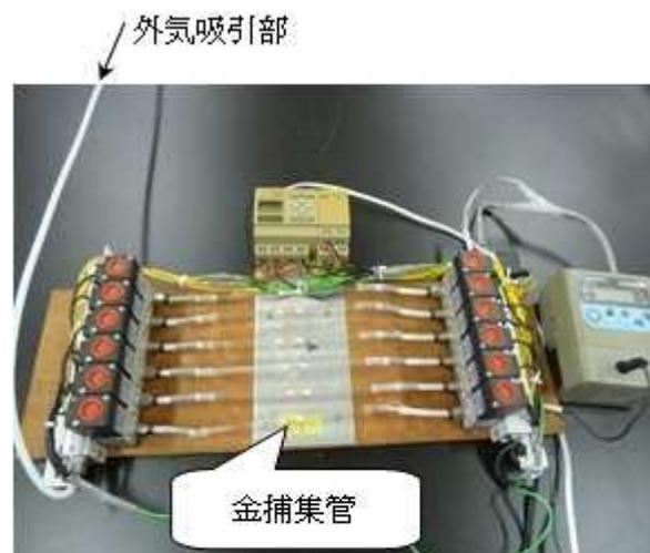
図(2)-7 連続水銀サンプリング装置
