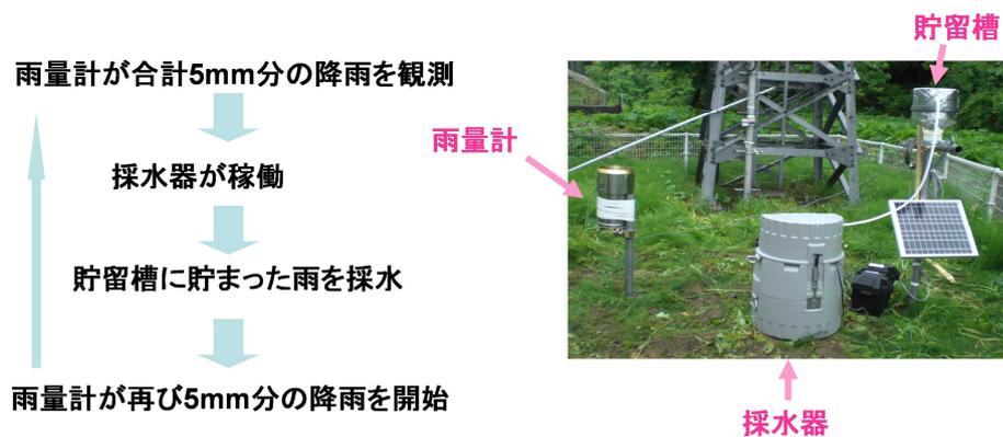
図(1)-7 降水中水銀測定自動採水器の概要
