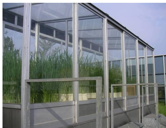
写真-2-1 外気オゾン濃度比例追従型のオープントップチャンバー
