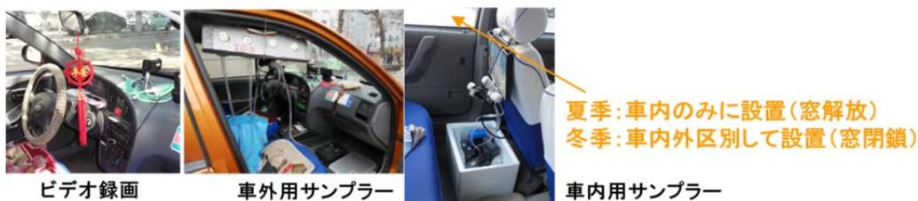
図(1)-8 タクシー車内外に設置した捕集装置類
