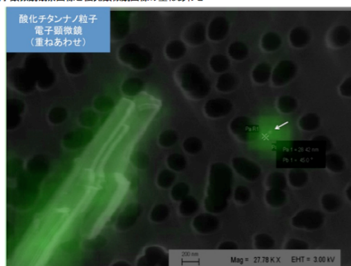
図9、高輝度蛍光色素を用いて検出できた酸化チタンナノ粒子の電子顕微鏡観察結果。マーカー(蛍光標識したアスベスト)の位置からナノ粒子の位置を推測し、拡大していくと約28000倍の倍率ではっきりと28nmのナノ粒子であることがわかった (A)。電子顕微鏡と蛍光顕微鏡の観察を重ね合せた結果、両者がよく一致している様子がわかる (B)。
