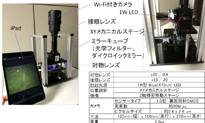
図11、WiFi機能つきカメラを利用した小型蛍光顕微鏡の試作
