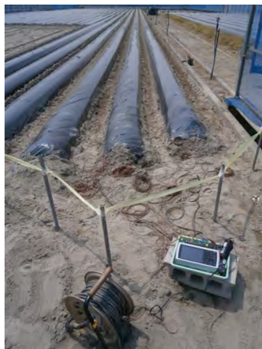
図(1)-4 徳島県の砂質土壌におけるサツマイモ栽培での土壤くん蒸実験 熱電対によりフィルム温度の測定 畝幅：75cm：畝50cm、通路25cm 薬剤：クロピク80(クロルピクリン80.0%)畦頂点に30cm間隔で3ml/穴処理 被覆資材：農ポリ0.3mm厚
