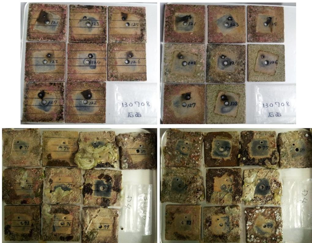
図(2)-20 サンゴ着底板上に付着した付着物（生物および泥）．上，最も付着物が少なかったサンプル（左は表で右は裏）；下，最も付着物が多かったサンプル（左は表で右は裏）
