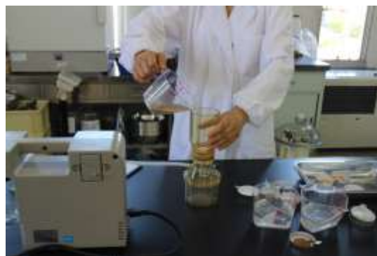
図 99 濾過器による細粒分量計測
