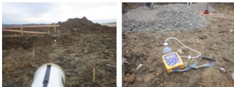
図 115 レーザーメタン計を用いた表層上のメタン調査（左図）及び GA2000 を用いた表層中のガス調査
