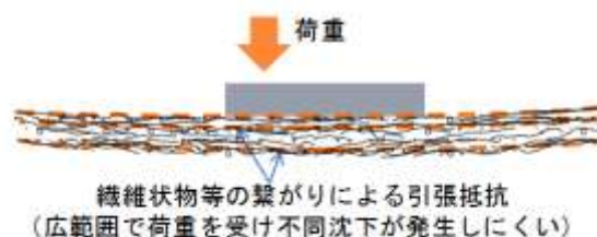
図 134 プラスチック等が混入した廃棄物地盤の荷重分担のイメージ
