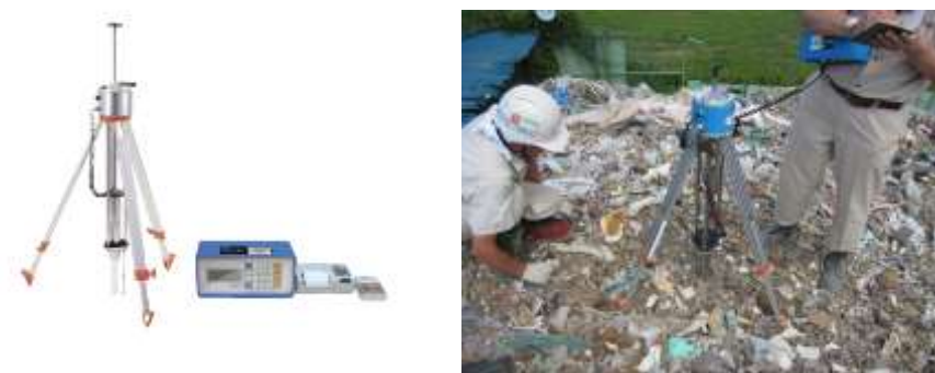
図 21 キャスポル（左；測定器の本体と表示部 右；測定状況）
