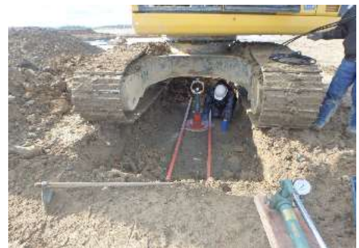
図 129 平板載荷試験 (廃棄物層上覆土厚 50cm の位置)
