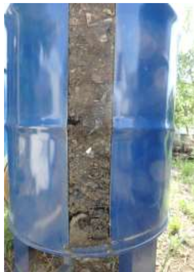
図 98 注水 6 ヶ月後の実験容器内 (中部試料、残水量 3.3ℓ、少量の排水継続中)
