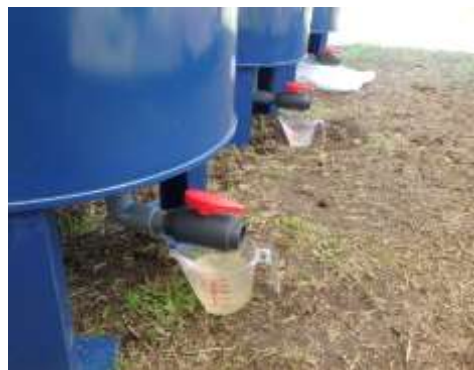
図 90 注水排水実験（注水状況）
