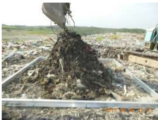
図 75 安息角試験（中部①現場） （プラスチック等の長尺物が混入）
