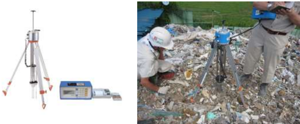
図 68 キャスポル（左；測定器の本体と表示部 右；測定状況）
