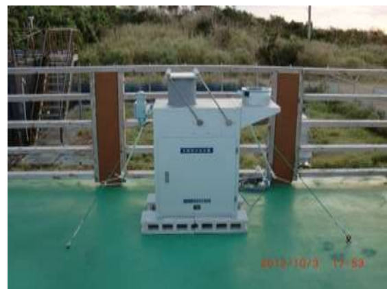
図(5)-2 辺戸岬ステーションに設置したダスト沈着物サンプラー（降水を感雨器が検知すると、蓋が自動で向かって右側へ動き、降水が止むと左側に戻る）
