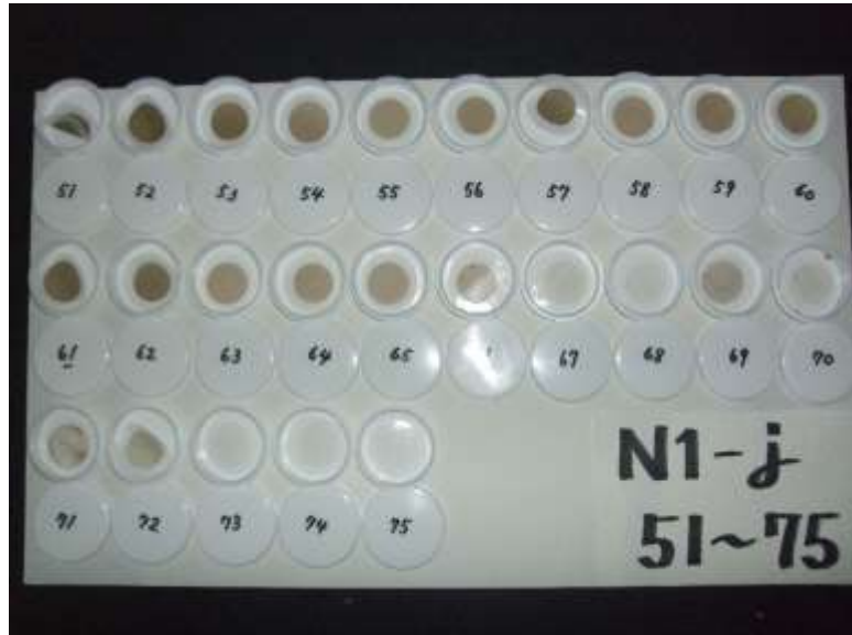
図(5)-6 ろ過後のフィルター残渣の例(フィルター直径は25mm, 左上のフィルターは有機物量が多いためにカーリングしている。残渣物の内容により色が異なる)
